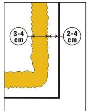
Pozn.: Delší prodleva mezi aplikací PUR pěny a přiložením k podkladu snižuje přídržnost. Všeobecně se u všech druhů PUR pěny začíná po cca 5 minutách tvořit povrchová nelepkavá slupka, která sniží tuto přídržnost. Stejně tak nedostatek prostoru na lešení ve výškách a vítr neumožní připravovat několik EPS desek s PUR pěnou v předstihu.
